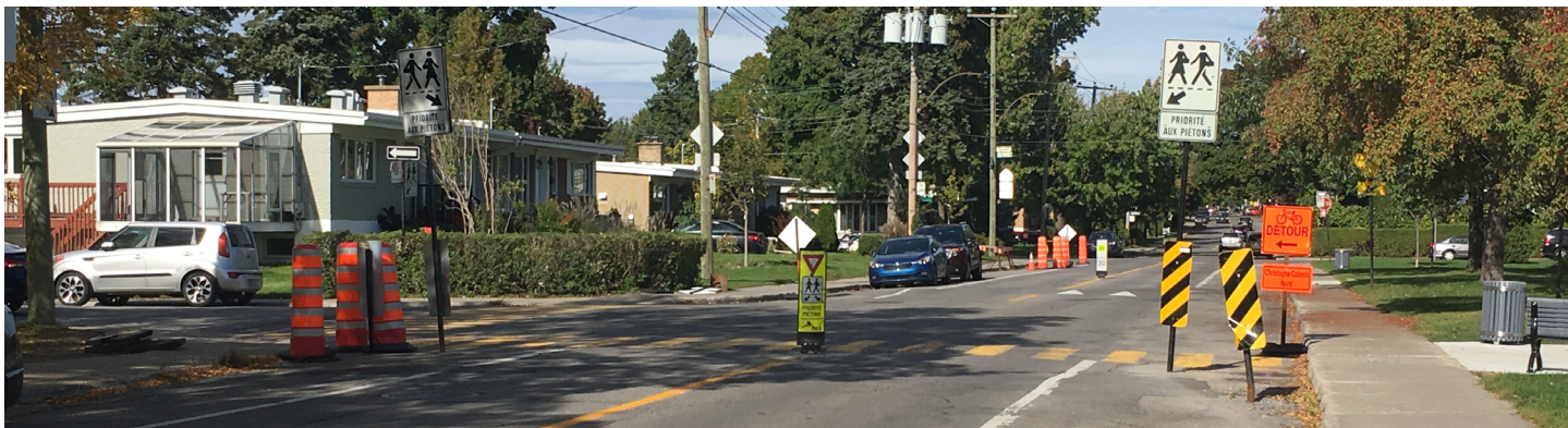
Signalisation latérale combinée à une balise centrale, rue Sauriol Est
