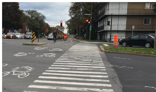
Exemple d'un aménagement avec îlot qui offre un refuge aux piétons, intersection de l'avenue Christophe-Colomb et du boul. Henri-Bourassa.
