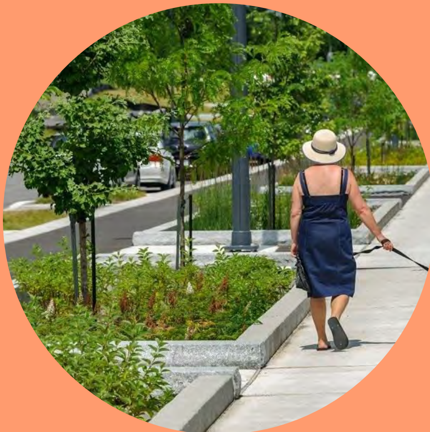
Photo 5.1.1c – Lisière plantée séparant chaussée et trottoir, Laval
