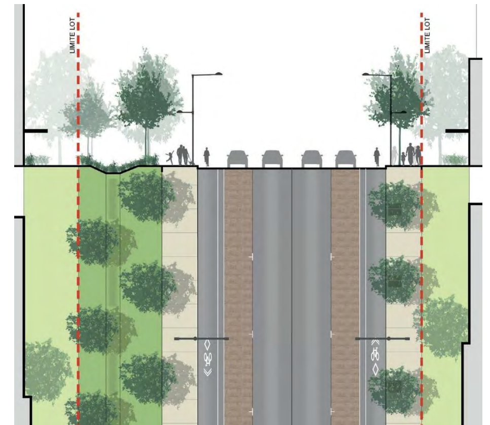
Figure 4.3d – Collectrice de 28,8 mètres
